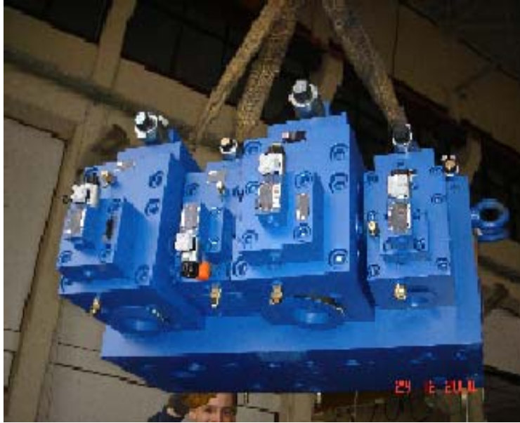
Şekil 1. Hurda balya presi yeni model “ Modül bloğu “
