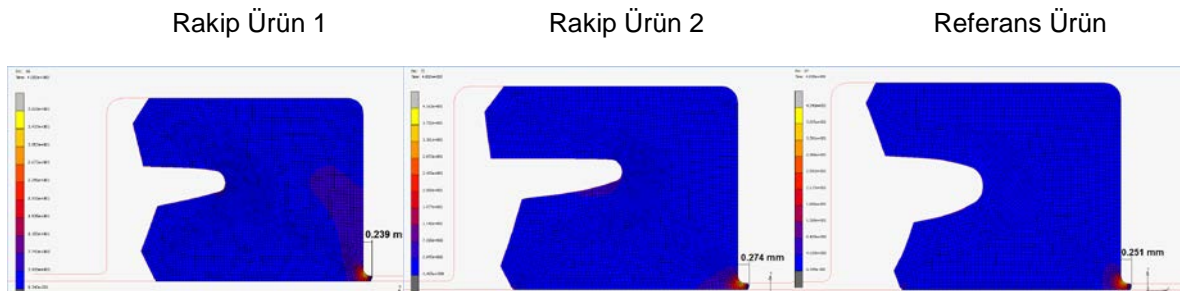
Şekil 12. Rakip Ürün / Referans Ürün 400 bar Basınç Altındaki Akma Miktarları ve İç Gerilim Değerleri
