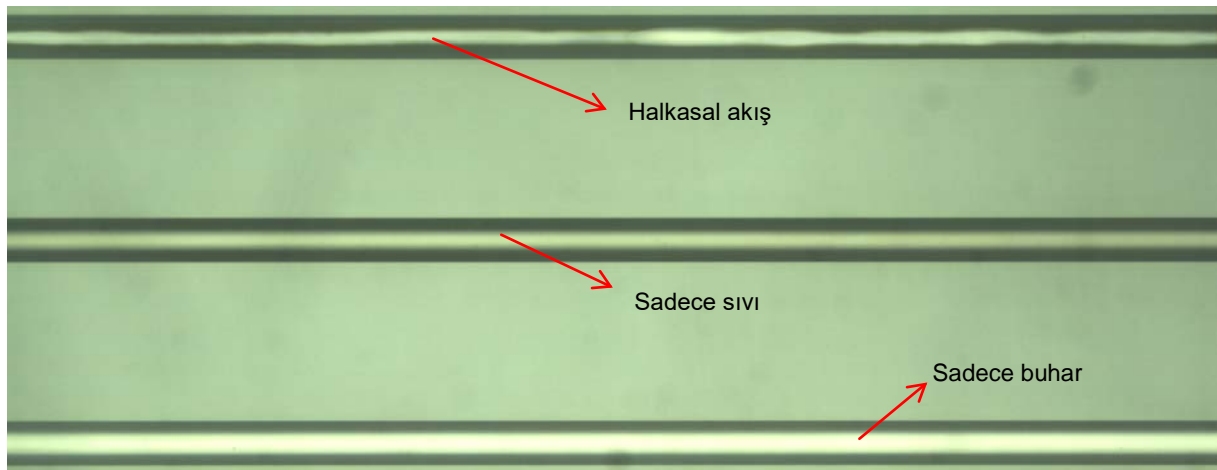
Şekil 6. Kanal girişinden 41.5 mm uzaklıkta, G = 238 \text{ kg m}^{-2} \text{ s}^{-1} ve \dot{q} = 51.9 \text{ W} için paralel kanallardaki akış desenleri.
